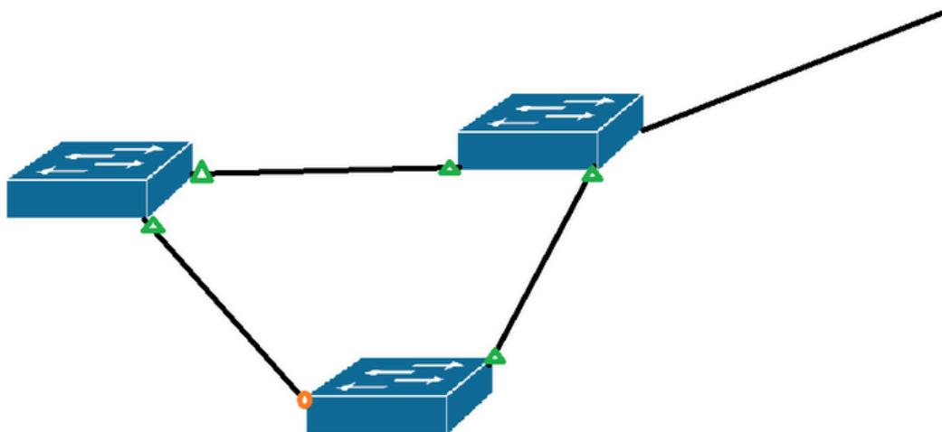
Cisco choisi donc le port en mode listen grâce au BPDU et réactive un port grâce au BPDU dans le cas où un des ports coupe.
