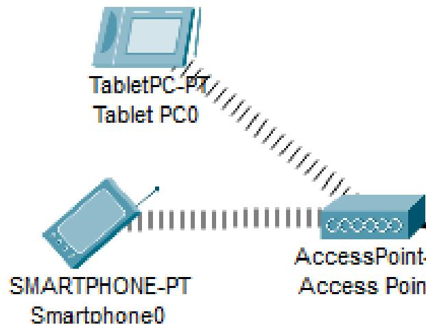
Pour assurer la sécurité il est demandé d'utiliser une clé WEP, pour les VLAN j'ai mis sur le VLAN le port de l'AP connecté au switch.
